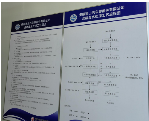
含磷废水处理系统工艺流程图
